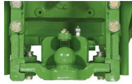
Insert d'attelage à rotule – AL225421
